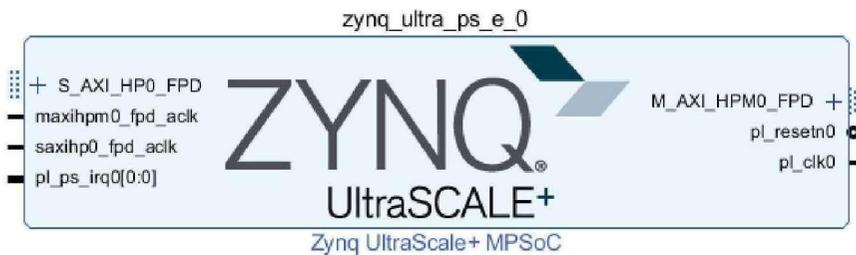
图 5-3 Zynq Ultrascale+ 系统 IP 核配置
